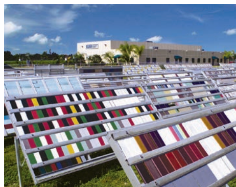
平版印刷油墨在极端环境下的耐光性测试由位于佛罗里达州和亚利桑那州的Q-Lab老化研究服务中心测试机构提供。
