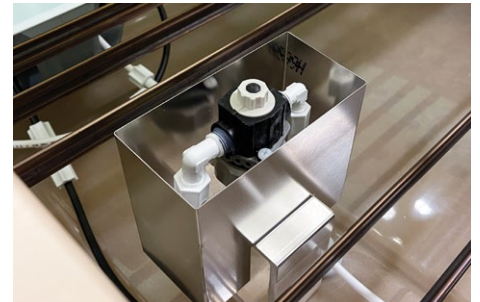
Buse de brouillard
