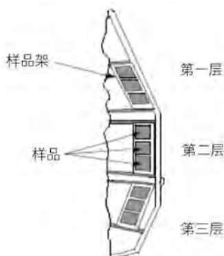
图3 旋转鼓式样品架中的样品安装
