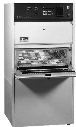
El espectro total de las lámparas de arco de xenón de la Q-SUN emite en el UV, luz visible e infrarrojo.
