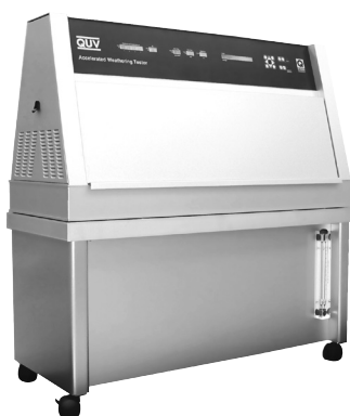
La cabina de envejecimiento acelerado "QUV" es la más usada alrededor del mundo.
