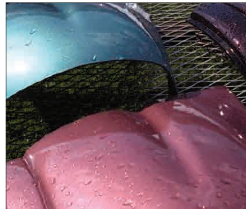
Usando un mecanismo de condensación único, la cámara QUV reproduce el rocío, que es la causa principal de humedad a la intemperie.
