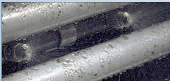
La cámara QUV/spray reproduce los efectos dañinos del choque térmico y la erosión mecánica.
