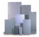
50多年来,Q板包括钢板和铝板已被公认为标准测试底板,能提供均匀、一致的测试表面,用于测试油漆、粘合剂、密封胶和其它涂料。
