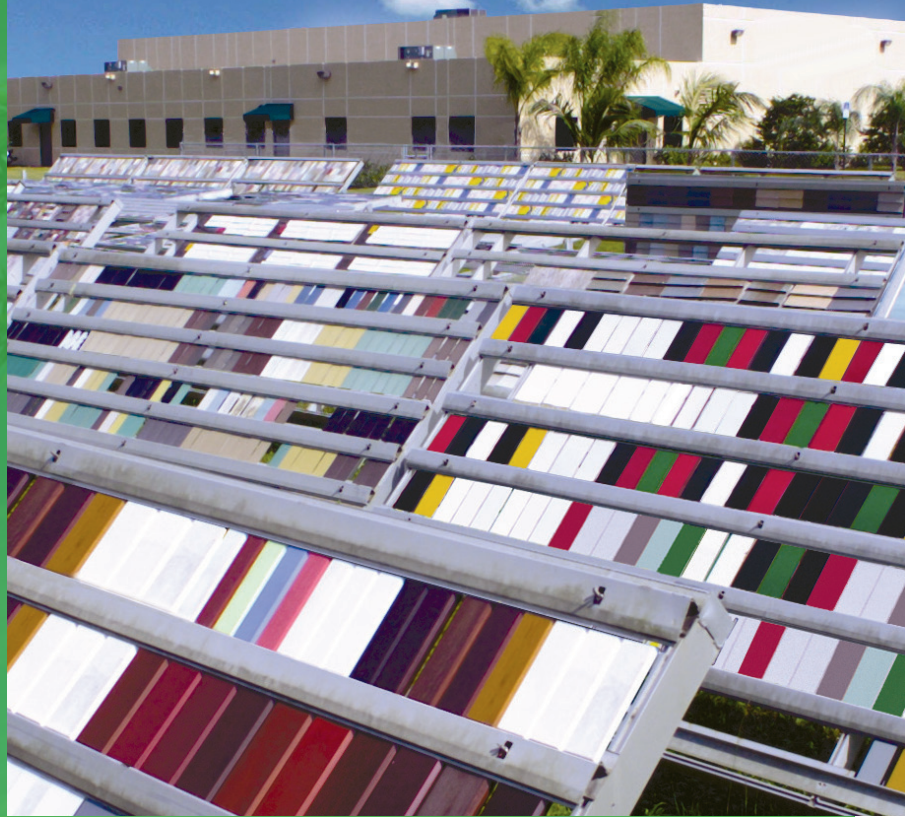
Standardmäßige Direktbewitterung im 45°-Winkel
