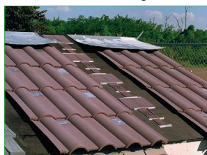
Befestigung von Spezialteilen, Direktbewitterung
