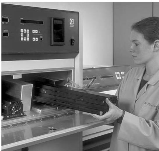
Q-Sun 的灯管更换非常容易，只需打开铰链门，断开灯座链接，即可拉出灯座。
