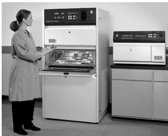
Q-Sun 氙灯试验箱模拟全光谱太阳光，并经过滤去掉不必要的光谱。
