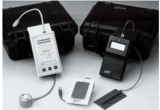
使用 CR20 辐照度校准仪和 CT202 温度校正仪可以方便地进行必要的校准。
