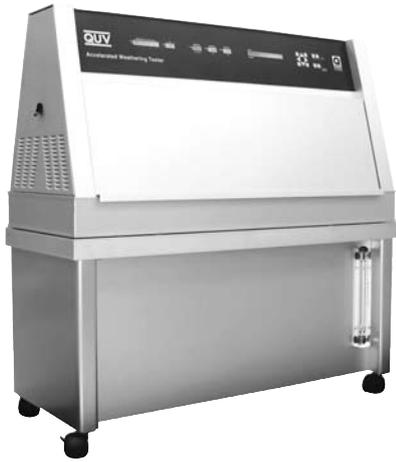
QUV使用荧光紫外灯管来模拟太阳光对经久耐用材料的破坏作用。
