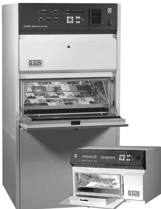
Q-Sun 氙灯试验箱既有全尺寸立式的，又有台式的，以满足您不同测试样品的需求。
