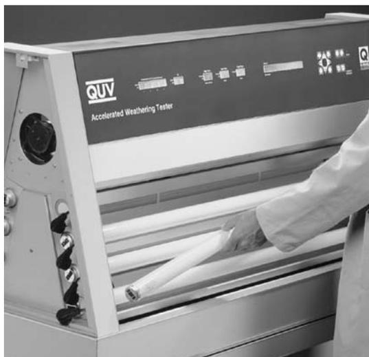
QUV/se 不需要轮换灯管。然而，当更换灯管时，两侧都有翻盖门的设计使得更换灯管很容易。
