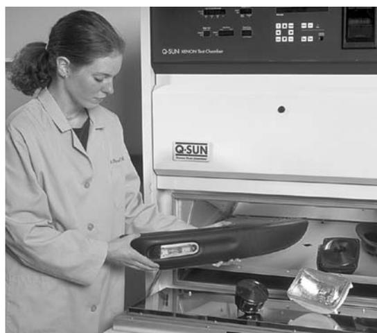
Q-Sun Xe-3除了可安装平板样品，还可安装三维部件、试管及培养皿等。
